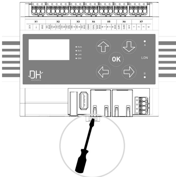
*Zur Demontage von der Hutschiene – Klammer nach unten ziehen*
